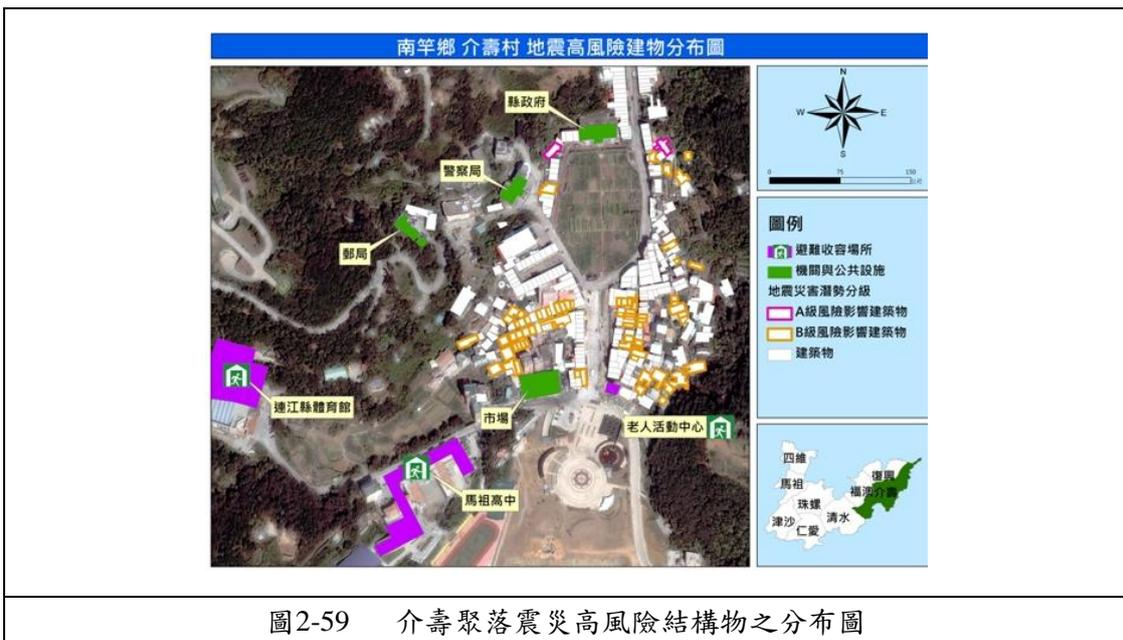
圖2-59 介壽聚落震災高風險結構物之分布圖
